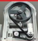
Réduction mécanique par poulies et courroies
